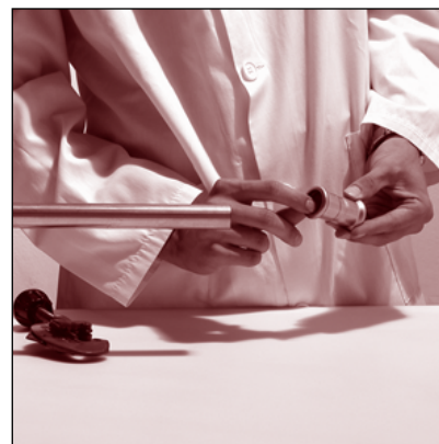
Rys. 23 | Sprawdzian obecności i pozycji uszczelki O-ring
