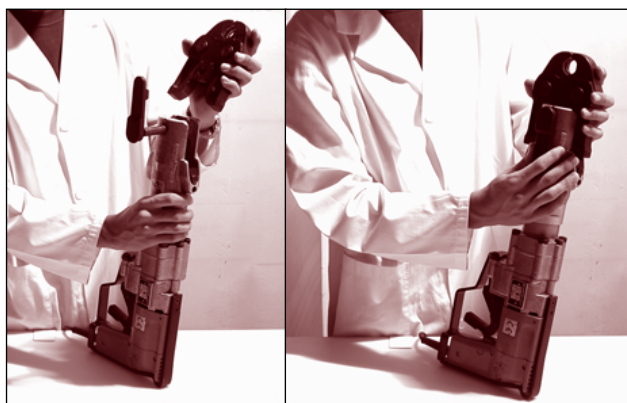
Rys. 27 | Przygotowanie narzędzia do zaprasowywania
